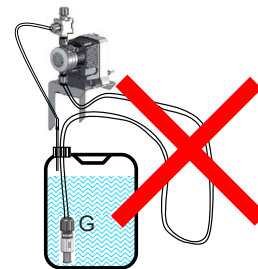
Fig. 652. Representación de la conexión de la bomba dosificadora entre el bidón de salmuera y la base del generador.
